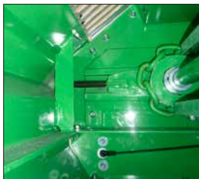
Espacio aumentado alrededor de los tensores de la cinta
